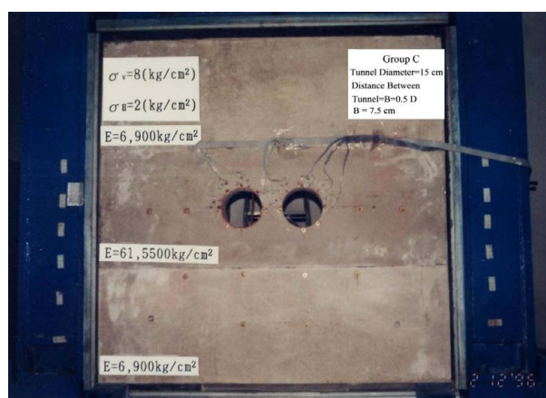
Slika 4. Model za ispitivanje dva paralelna bliska tunelska iskopa sa instrumentima: a – pre iskopa; b – posle iskopa
